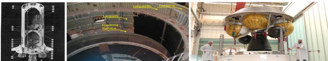
Figura 1.3: Refuerzos internos e intercargas IF de propulsión en los lanzadores.
